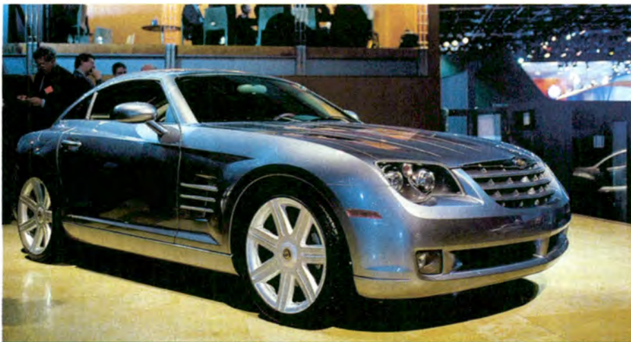
El Chrysler Crossfire comparte su motor (un 3,2 de 200 CV) y su plataforma con el Mercedes-Benz SLK.
